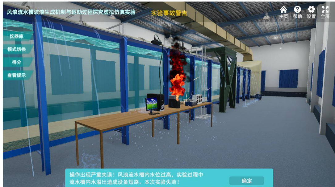
图 2-8-5 水位过高时造成危险
